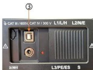
Figuur 9.2: USB-connector bevindt zich aan de bovenzijde van de MFT-behuizing
